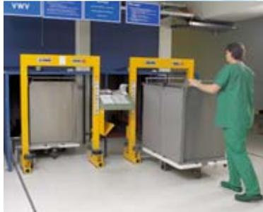
Determinadas codificaciones, como p.e. integradas en el paragolpes, procuran que el carro de transporte llegue de forma segura a la zona y posición predeterminada.
