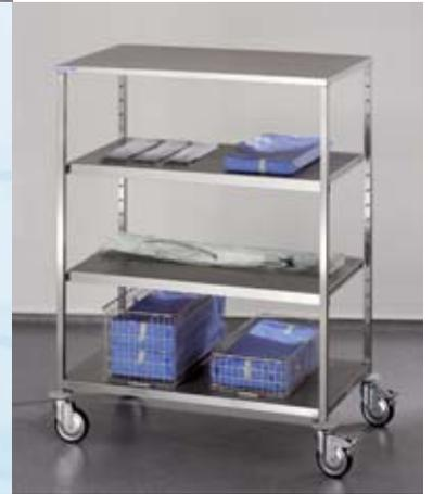
El tren de rodadura se compone de 4 ruedas giratorias, 2 de ellas con freno y bloqueo, con doble cojinete, en carcasa galvanizada-cromada, Ø 125 mm. El juego de ruedas es antiestático. Otras versiones, como p.e. ruedas aptas para túnel de lavado o esterilizables se pueden servir bajo demanda. Separadores de material sintético protegen los carros de desperfectos durante el transporte.
