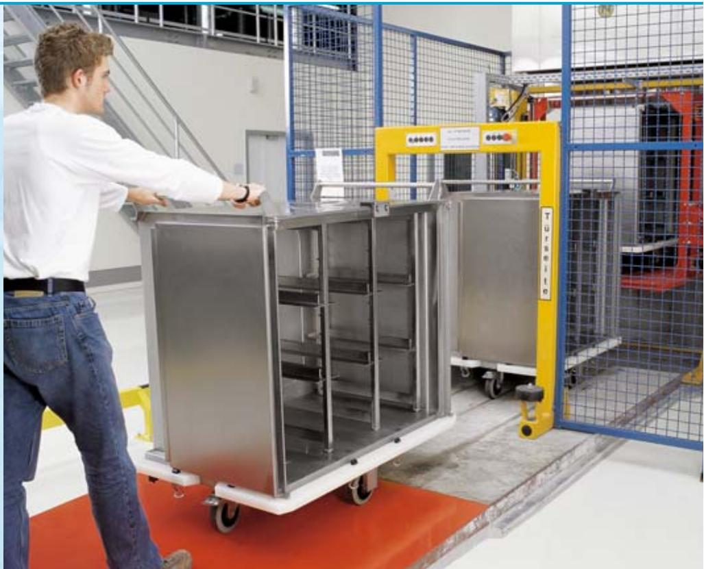
Especial para el transporte automático de carros (AWT) HUPFER® desarrolló carros para transporte de contenedores y estériles - aquí en la entrada automática a un túnel de lavado multicámara.
