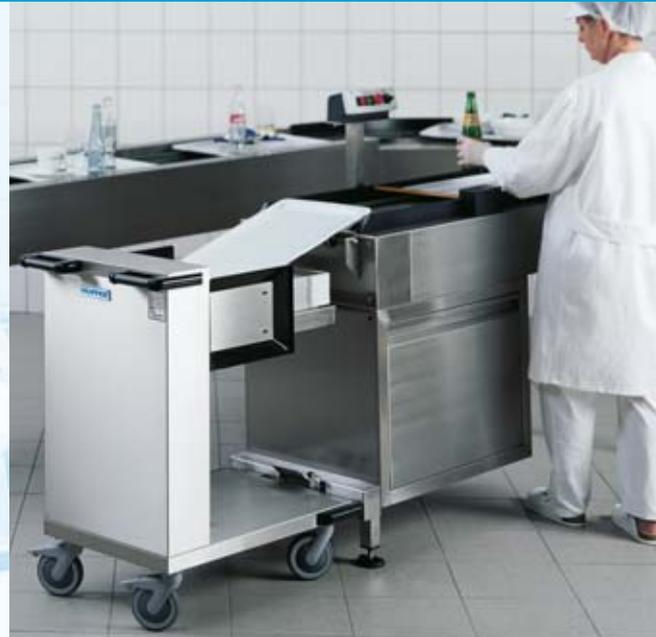
Apilador de bandejas OTA/53-37 S en el apilado de bandejas en una cinta HUPFER® de recogida de vajilla sucia.
