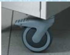
Todos los aparatos apiladores de la marca HUPFER® se presentan con ruedas resistentes a la corrosión, con cojinetes y sin mantenimiento según norma DIN 18867-8. Cada aparato dispone de 4 ruedas giratorias, 2 de ellas con freno y bloqueo, Ø 125 mm. La capacidad de carga de cada rueda es de 100 Kg.
