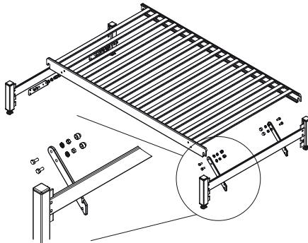
**D** Bringen Sie jeweils eine Querstrebe an einer Ecke des U-Rahmens an. Schieben Sie dafür die Nut in die Führung.
