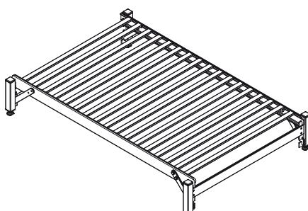
**D** Justieren Sie die höhenverstellbaren Schraubfüße durch Herausdrehen so, dass der Bodenrost waagerecht ausgerichtet ist.
