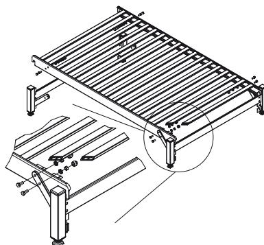
**D** Legen Sie die Rostauflage auf. Verschrauben Sie die vier Querstrebren mit der Rostauflage.
