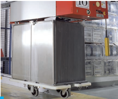
Trasporto carrelli automatizzato con binario trasporto elettrico sospeso dal soffitto
