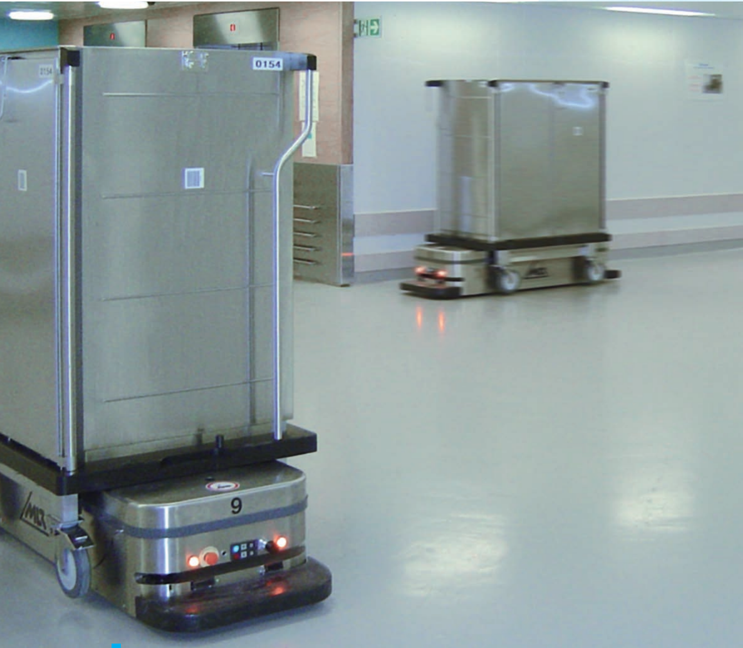
Trasporto carrelli automatizzato a pavimento con sistema di trasporto senza conducente (FTS)
