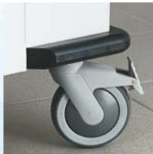
De serie los aparatos están equipados con ruedas sintéticas resistentes a la corrosión con cojinetes y sin mantenimiento según DIN 18867-8, con protección contra hilos, Ø 125 mm. Cada aparato con 2 ruedas giratorias con freno y bloqueo y 2 ruedas fijas. Además los aparatos pueden servirse bajo pedido con ruedas de Ø 160 mm ó Ø 200 mm. Para una mejor conducción existe la opción de una rueda fija central.
