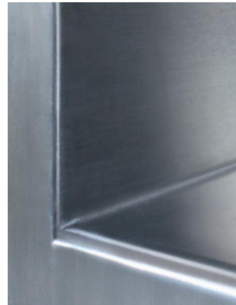
Bei **Hygienestufe H1** sind Böden und Seitenteile der Korpusse ebenfalls fugenlos verschweißt und bilden innen mit rund 3 mm einen kleineren Kugelradius. H1-Korpusse werden für hygienisch gering bis mittelstark beanspruchte Bereiche empfohlen.
