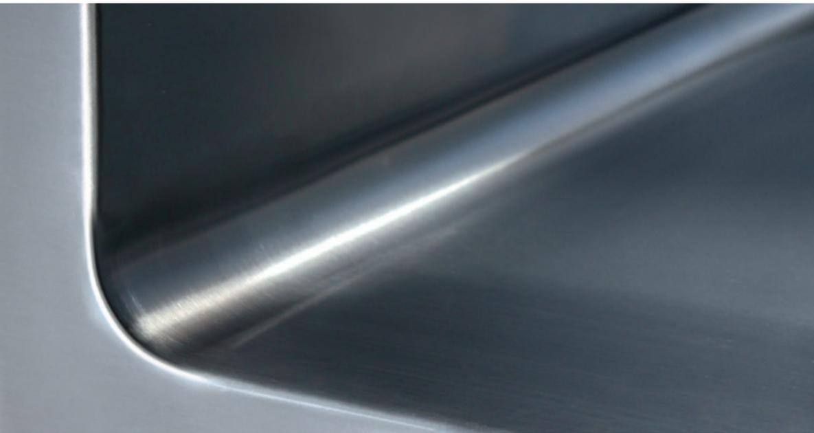
Bei **Hygienestufe H2** sind Böden und Seitenteile der Korpusse fugenlos verschweißt und bilden innen einen Kugelradius von rund 20 mm. Der extragroße Radius schafft beste Voraussetzungen für eine besonders gründliche Reinigung und sorgt damit für ein deutlich reduziertes Keimrisiko. H2-Korpusse bieten daher auch in hygienisch stark beanspruchten Einsatzbereichen maximale Sicherheit.
