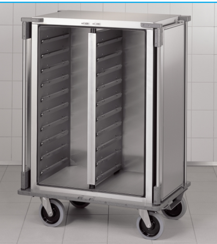
TTW-V 2/40 B-EN pour des plateaux Euronormes 530 x 370 mm ou Gastronormes 530 x 325 mm. La partie interne est composée de 2 compartiments de 2 x 10 = 40 plateaux, au pas de 115 mm. Chariot représenté ici avec un pare choc gris.
