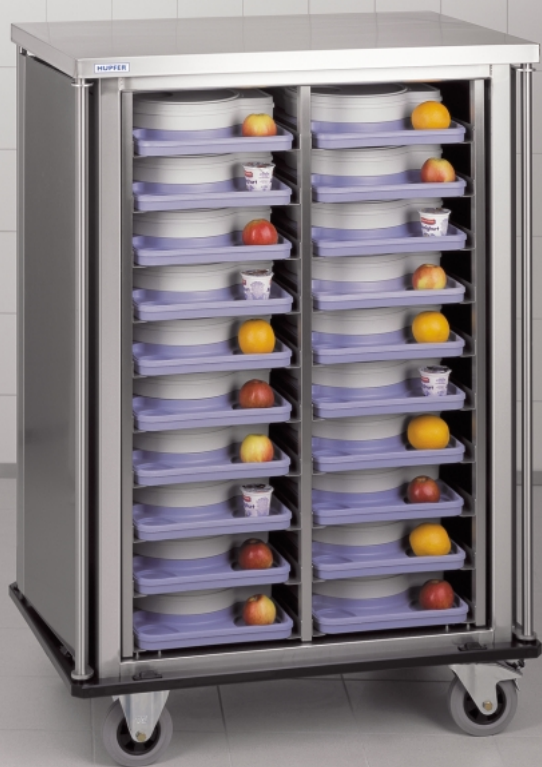
ETTW 2/20 L-EN pour des plateaux euronormes 530 x 370 mm. L'espace intérieur se compose de 2 compartiments de 10 plateaux chacun, au pas de 115 mm.
