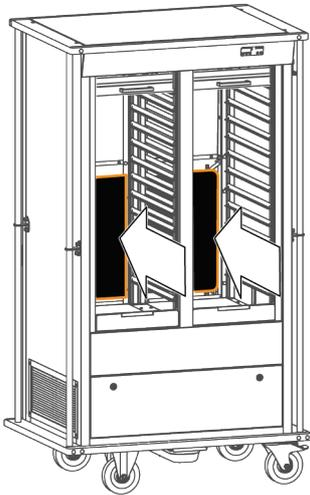
Verunreinigungen am Verdampfer behindern den Luftstrom, z. B. Eis und Staub. Durch die Verunreinigungen wird die Kühlung ineffektiv und die Speisenkomponenten können nicht mehr bestimmungsgemäß gekühlt werden. Die Steuerung verfügt über eine Enteisungsfunktion. Unter bestimmten Umweltfaktoren können eine manuelle Enteisung und Reinigung notwendig sein, z. B. heiße Außentemperaturen und feuchtes Klima. Vereisungen dürfen nicht mit chemischen Eisentfernern oder Wärmequellen beseitigt werden.
