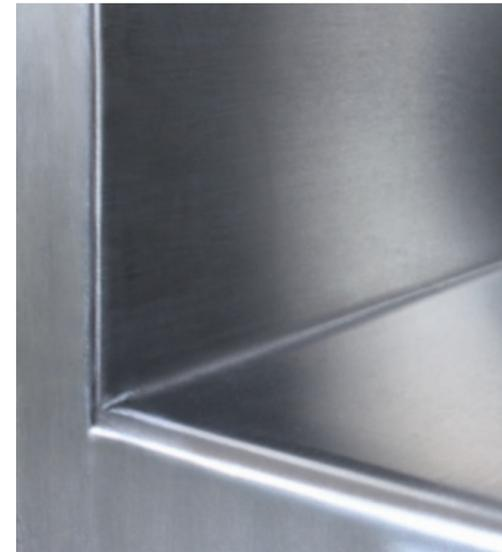
Bei **Hygienestufe H1** sind Böden und Seitenteile der Korpusse ebenfalls fugenlos verschweißt und bilden innen mit rund 3 mm einen kleineren Kugelradius. H1-Korpusse werden für hygienisch gering bis mittel-stark beanspruchte Bereiche empfohlen.
