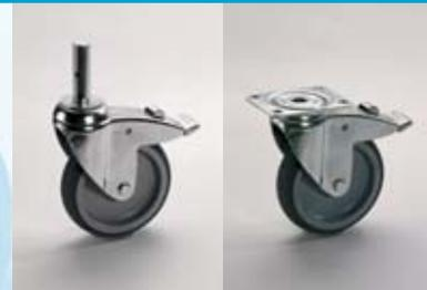
Ruote di serie, con telaio in acciaio zincocromato, struttura in polipropilene, fascia in gomma e mozzo a foro passante. Per il fissaggio al carrello sono disponibili due versioni: con perno o con piastra.
