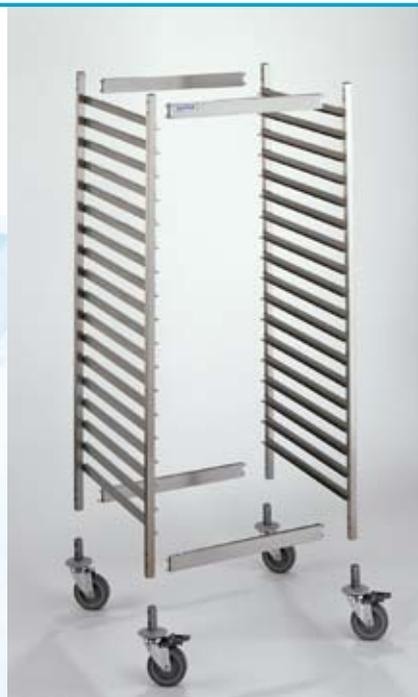
Il carrello portateglie RWG/18Z, come si può vedere dalla foto, è completamente smontabile. Si assembla velocemente e senza problemi. È dotato di 18 paia di guide a "C" per l'inserimento dal lato 530 mm. ed ha una capacità di 36 vassoi GN 1/1 o contenitori GN 2/1, 1/1 e 2/4.
