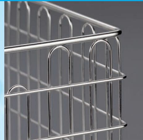
La speciale costruzione continua con curvature dei cestelli per attrezzi sterili HUPFER® garantisce la massima sicurezza del lavoro e incredibili caratteristiche di pulizia. Le estremità delle curvature sono saldate centralmente al tondino perimetrale - non ci sono spigoli appuntiti o sporgenze.
