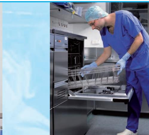
Grazie alla possibilità di impilare i cestelli per gli attrezzi sterili è possibile il lavaggio di un'elevata quantità di attrezzi nella lavastrumenti.
