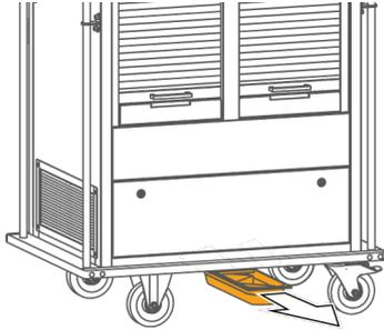
1. ➤ Entfernen Sie den Kondensatauffang aus der Halterung.
