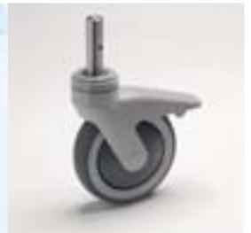
Rueda inoxidable de plástico con rodamiento a bolas, apropiado para la utilización en entornos mojados. Con sujeción por vástago de acero inoxidable 18/10, material 1.4301.
