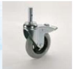
Rueda protegida de la corrosión con neumático de material sintético símil aire, con rodamiento a bolas en carcasa galvanizada - cromada. Este tipo de rueda procura el mínimo ruido en movimiento y es especialmente apropiado para pisos irregulares.
