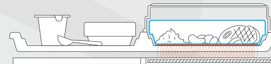
**Perfekt auf den Punkt: Beim Regenerieren per Induktion werden nur Speisen erwärmt, die erwärmt werden sollen. Gekühlte Speisen bleiben gekühlt.**
