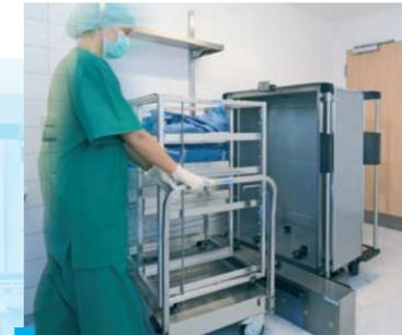
Acoplamiento a un zócalo de transferencia
