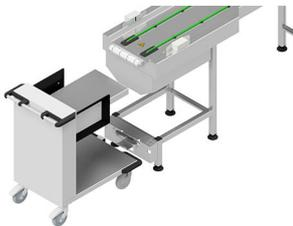
**Dispositif d'accrochage** Pour l'empilage de plateaux vides sur des chariots niveau constant à plateaux ouverts (OTA). Les plateaux sont acheminés depuis la bande sur le chariot niveau constant à plateaux jusqu'à ce que ce dernier soit plein et que les plateaux s'empilent. Le convoyeur s'arrête lorsque le chariot niveau constant à plateaux est plein ou lorsqu'aucun chariot niveau constant à plateaux n'est à quai.
