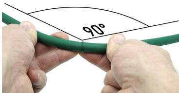
Fig. 9 : Contrôler la soudure
