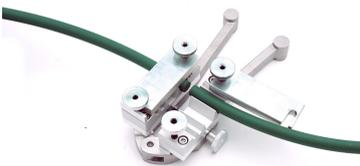
Fig. 6 : Serrer une courroie ronde
