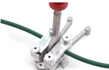
Fig. 7 : Mise en place de la spatule à souder
