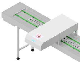
**Collecte automatique des couverts** grâce à un aimant, les couverts détectables magnétiquement sont soulevés du plateau et expulsés en dehors du convoyeur, par exemple dans un chariot pour couverts, un conteneur ou une goulotte de démagnétisation. Le sens de direction de la collecte des couverts est tourné de 90° par rapport au sens de direction du convoyeur.
