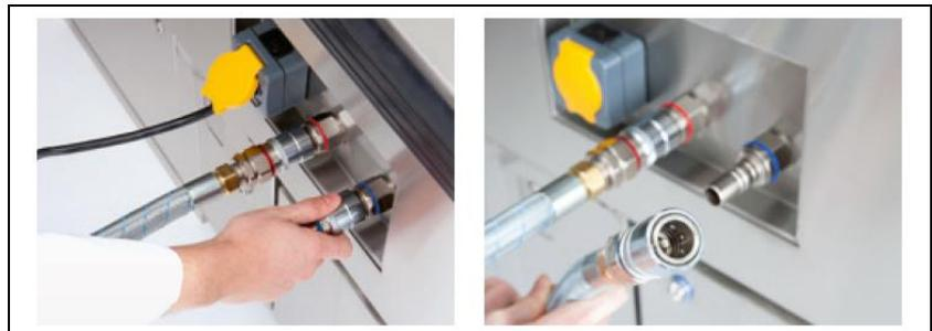
*Schnellkupplung am Kühlkreis-Anschluss lösen*
