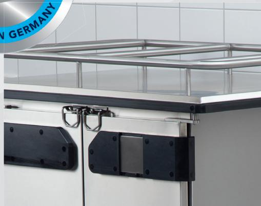
Die massive verschweißte Galerie unterteilt das Wagendach in zwei unterschiedliche Abstellflächen (Sonderausstattung). Eine Fläche für 2 x GN 1/1-100 und für einen Bäckereikorb 600 x 400 x 170 mm. Galeriehöhe 85 mm.
