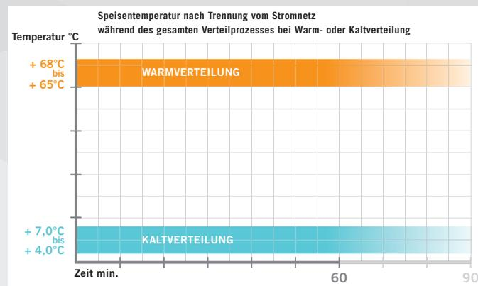
Temperaturstabilität über den gesamten Verteilprozess. Ganz gleich, ob bei Warmverteilung, Kaltverteilung oder beides in Kombination.
