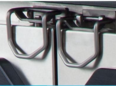
Der Türschließmechanismus mit integrierter Zweipunktverriegelung hält die Türen auch auf unebenen und holprigen Fahrwegen sicher geschlossen. Die Türöffnung selbst ist mit nur einer Hand bedienbar.
