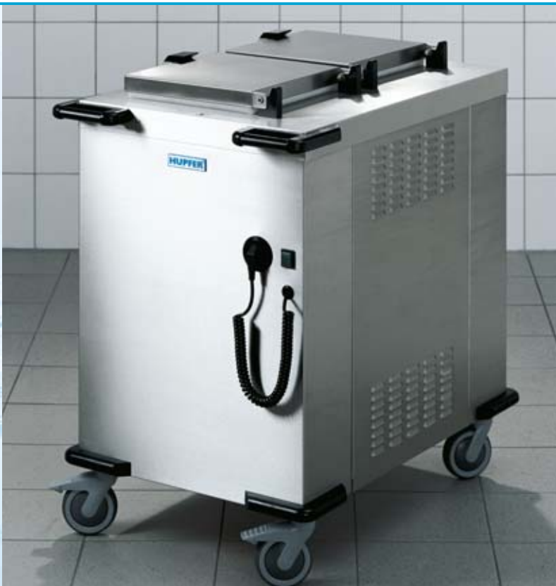
Carrello distributore sottopiatte a due colonne con modulo energetico/ventilato TEUH-2/26 P. Specifico per il riscaldamento di sottopiatte in acciaio inox. Il sistema di ventilazione, unito alla potenza elettrica (3 kw) ed ai coperchi isolati termicamente, permette il riscaldamento di 2 pile x 44 sottopiatte sino al raggiungimento di una temperatura superiore a 120°C in circa 3 ore e 30 minuti.
