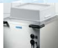
Carrello elevatore cestelli KOUH/50-50 (riscaldabile/ventilato). Piattaforma: cestello elevatore in acciaio rivestito in rilsan, dimensioni mm. 500x500x150p. Capacità: 6 cestelli h.115 mm. o 9 cestelli h. 75 mm. Pulizia perfetta e senza fatica, con l'estrazione dell'intera piattaforma.
