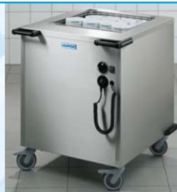
Carrello elevatore cestelli KOUH/50-50 (riscaldabile/ventilato). Piattaforma: cestello elevatore in acciaio rivestito in rilsan, dimensioni mm. 500x500x150p. Capacità: 6 cestelli h.115 mm. o 9 cestelli h. 75 mm. Pulizia perfetta e senza fatica, con l'estrazione dell'intera piattaforma.
