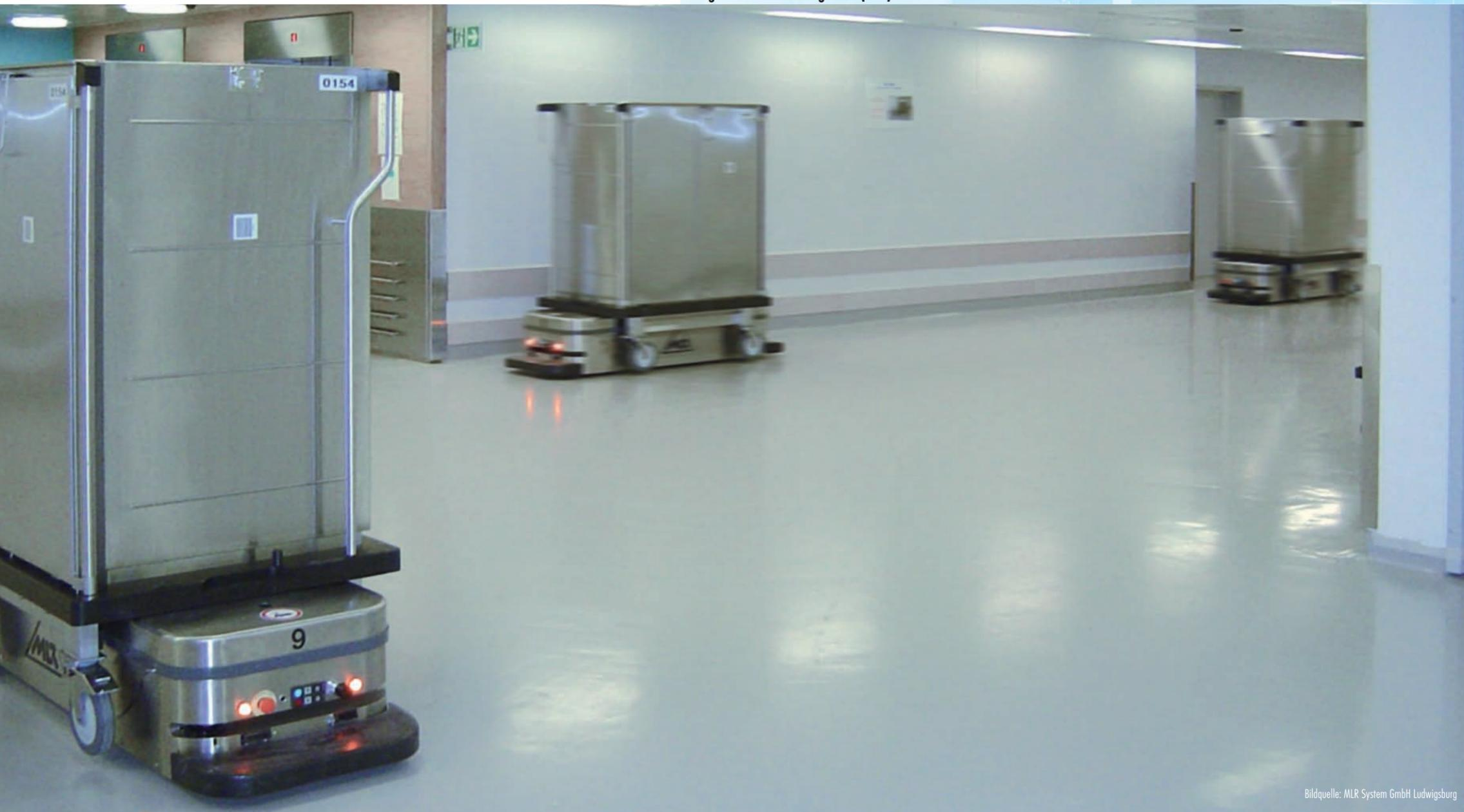
Automatischer Wagentransport, bodenfahrend mit Fahrerlosem Transportsystem (FTS)
