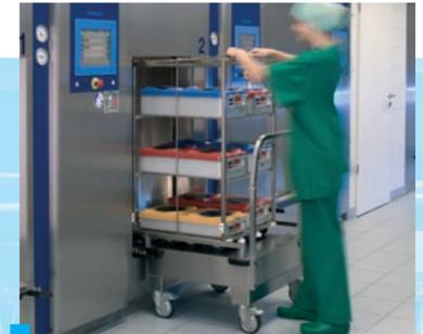
Übergabe des Einschubgestells in den Sterilisator mittels direkter Andockung
